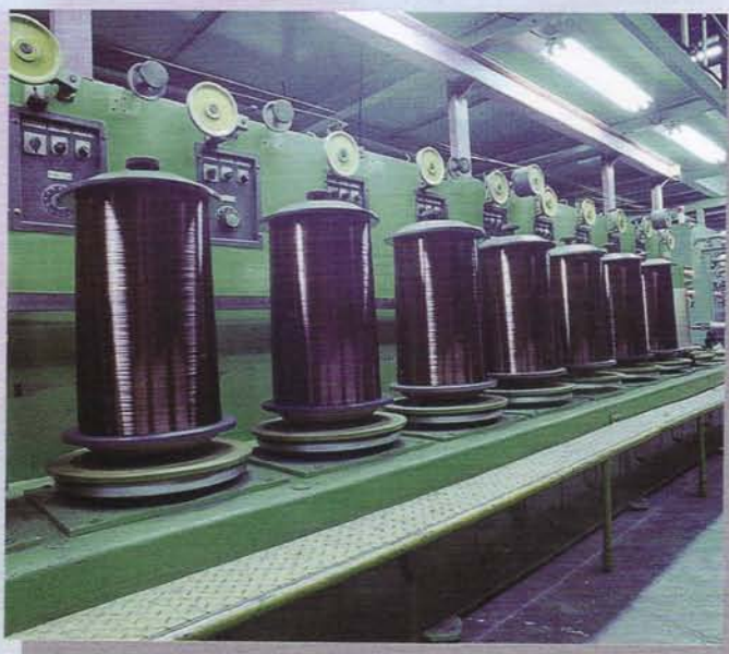
60~270kgs大軸捲取設備 60~270kgs bobbin take up system
