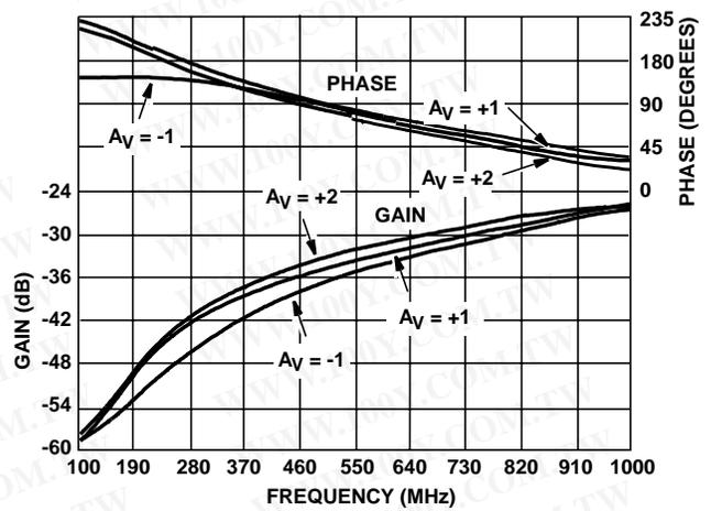
FIGURE 22. HIGH FREQUENCY REVERSE ISOLATION ( $S_{12}$ )
