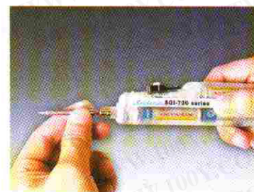
安装新的烙铁头
