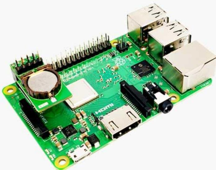
DS1307是低成本、高精度I2C实时时钟(RTC)，该器件包含电池输入端，断开主电源时仍可保持的计时Ds1307具有长期度，并减少了生产线的元件数量。DS1307提供商用级和工业级温度范围，采用8引脚64mil的SO封装,具有低功耗特性,在电池供电待机状态下,静态消耗电流低于500nA。
