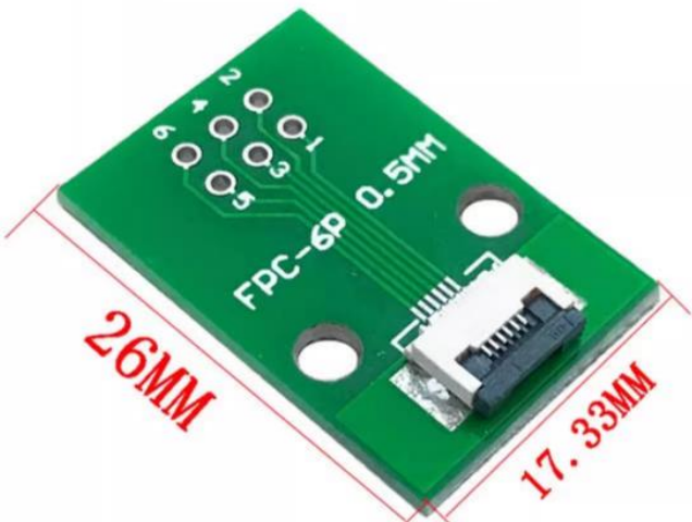
6PIN转接板焊好0.5MM座子
